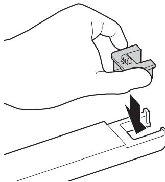
6. Mantenga la barra deslizante nivelada en horizontal e insértela en la ranura correcta. Luego, cierre la tapa de los tanques de tinta.
