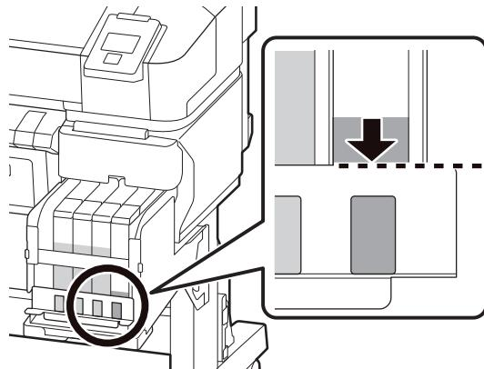
Si el nivel de tinta restante está por encima del borde superior de la placa metálica o es superior a 1,9 pulg. (50 mm) de la base del tanque de tinta, siga imprimiendo hasta que el nivel de tinta restante baje a 1,9 pulg. (50 mm) de la base del tanque; de esta manera, podrá utilizar toda la tinta de un paquete nuevo para llenar el tanque.
