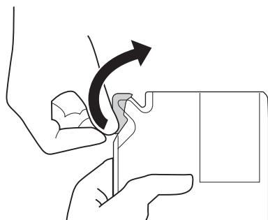
11. Insérez le bec verseur du sac dans l'ouverture et inclinez-le doucement pour faire couler l'encre.
