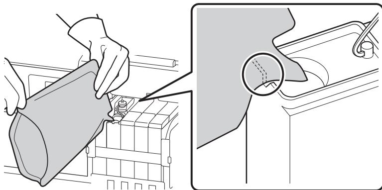
**Nota:** Asegúrese de vaciar toda la tinta del paquete en el tanque. No utilice un paquete para llenar varios tanques de tinta. Esto podría causar que no se muestren correctamente los mensajes de aviso de tinta restante.
