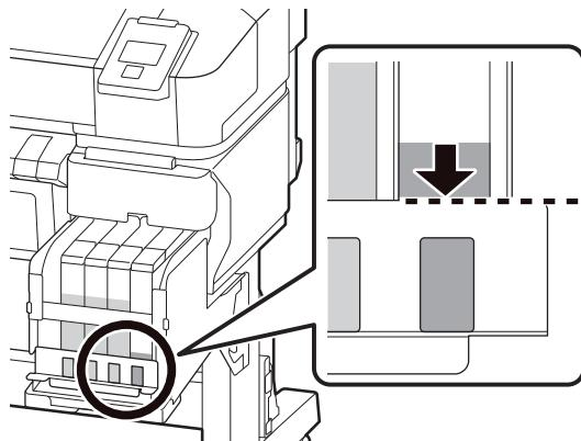
Se o nível da tinta restante estiver acima da borda superior da placa de metal ou acima de 50 mm do fundo do tanque, continue a usar a impressora até que o nível da tinta restante esteja a 50 mm do fundo do tanque, para que possa usar toda a tinta de uma nova embalagem para reabastecer o tanque.
