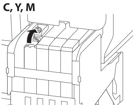
Pour l'encre noire haute densité, retirez le bouchon de l'orifice du réservoir d'encre et le bâtonnet, et accrochez le bâtonnet au réservoir d'encre.
