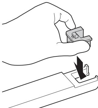
6. Segure a barra deslizante nivelada horizontalmente e encaixe-a. Feche a tampa do tanque de tinta.
