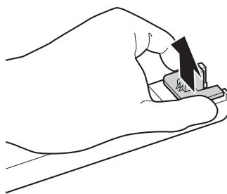
5. Confirme se a cor da etiqueta da barra deslizante corresponde à cor na nova embalagem da tinta. Depois coloque o chip fornecido com a nova embalagem de tinta na barra deslizante.
