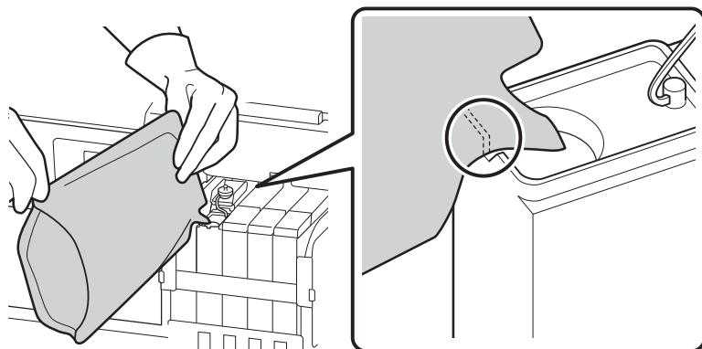
**Observação:** Esvazie a embalagem de tinta completamente dentro do tanque. Não use uma embalagem para recarregar vários tanques. Isso pode impedir a exibição correta de mensagens do sistema de aviso de tinta restante.
