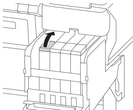
9. Pour les couleurs d'encre autres que le noir haute densité, retirez le bouchon de l'orifice du réservoir d'encre.
