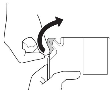
11. Insira o bocal da embalagem de tinta na ranhura e incline a embalagem lentamente para despejar a tinta.
