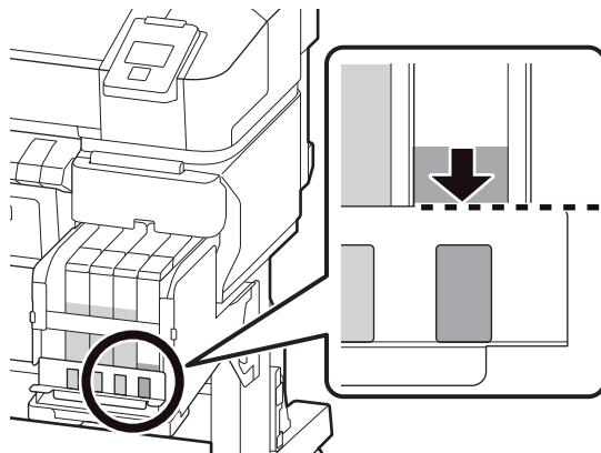
Si le niveau d'encre restante est au-dessus du bord supérieur de la plaque de métal ou supérieur à 50 mm (1,9 po) depuis le fond du réservoir d'encre, continuez à utiliser l'imprimante jusqu'à ce que le niveau d'encre soit à 50 mm (1,9 po) du fond du réservoir d'encre de façon à pouvoir utiliser la totalité de l'encre du nouveau sac pour remplir le réservoir.
