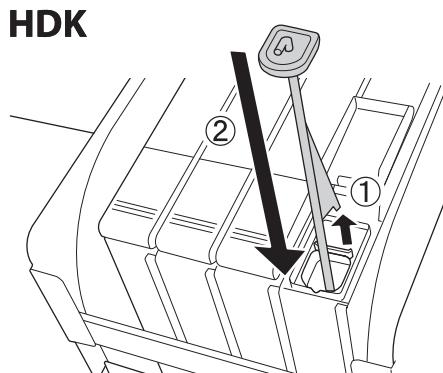
**Mise en garde :** Appuyez fermement sur le bouchon de l'orifice du réservoir d'encre. Si la réglette entre en contact avec le bouchon de l'orifice du réservoir lorsque vous la retirez, le bouchon pourrait subir des dommages.
