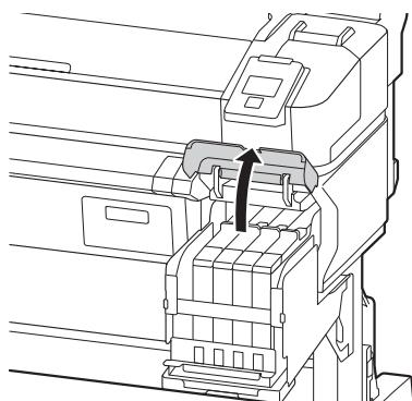
3. Insérez un doigt dans le creux au niveau de la partie supérieure de la réglette et tirez-la tout droit.
