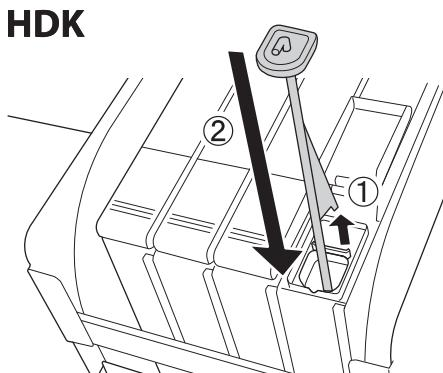
**Precaución:** Presione la tapa de caucho hacia abajo firmemente. Si la barra deslizante entra en contacto con la tapa de caucho al retirarla, la tapa se podría dañar.
