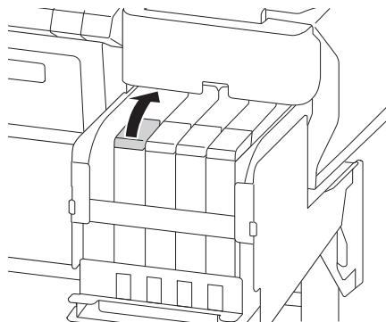
9. Para todas las tintas de color menos la tinta High Density Black (Negro de alta densidad), retire la tapa de caucho del tanque de tinta.
