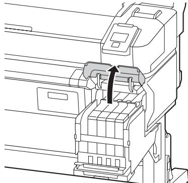
3. Coloque el dedo en el hueco superior de la barra deslizante y tire hacia afuera para sacarla.
