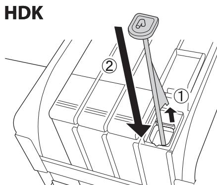
**Cuidado:** Aperte a tampa da entrada de tinta com firmeza. Se a barra deslizante entrar em contato com a tampa da entrada de tinta quando removê-la, a tampa pode ser danificada.
