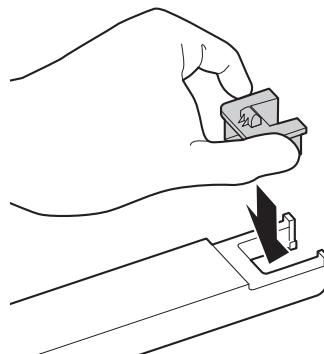
6. Tenez la réglette à l'horizontale et insérez-la. Fermez le couvercle du réservoir d'encre.
